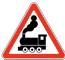
1.2 «Железнодорожный переезд без шлагбаума»
