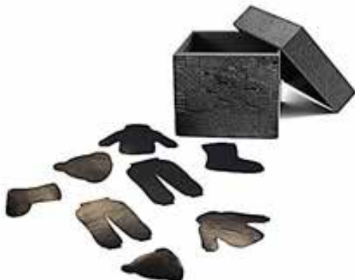
Рис. 37. Черный ящик и силуэты одежды для проведения опытов с использованием световозвращающих элементов
